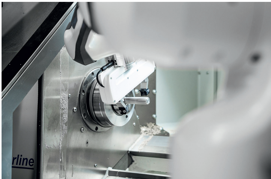
3 Die hohe Präzision der Bewegungsausführung verhindert Fehlbestückungen. Für das Programmieren werden keine speziellen Kenntnisse benötigt © TQ
